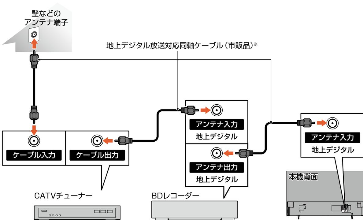
\* シールド性能が高いものをご使用ください。シールド性能が低いものでは、周囲のノイズの影響により受信性能が悪化する場合があります。
