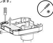
② USBケーブル®を組み付け、カバーの ツメを折ってからプラスドライバーを 用いてネジを締めます。
