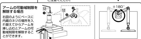
止めネジを六角レンチ小I2で緩めてからアームAIIを挿し込み、 止めネジを締め付けます。
