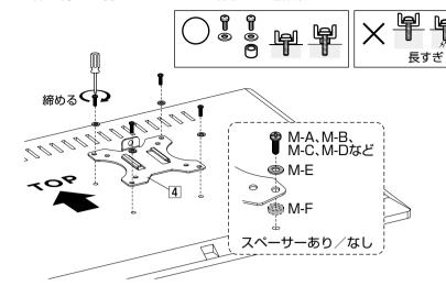
VESA プレートをアームに掛けて VESA プレート固定ネジ 回で固定 します。
