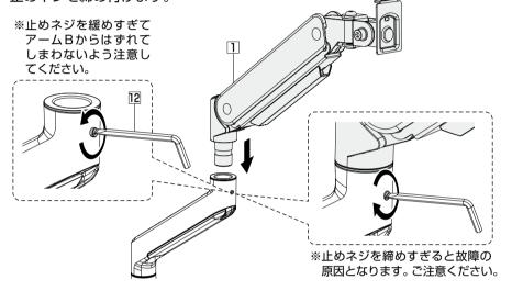
モニターの高さが安定するように六角レンチ大囮でネジを回し、ばねの力を調節 します。
