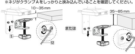
デスクにクランプを奥まで挿し込み、ハンドルを締め付けて固定した後に ケーブルマネージャー回をクランプに取り付けます。
