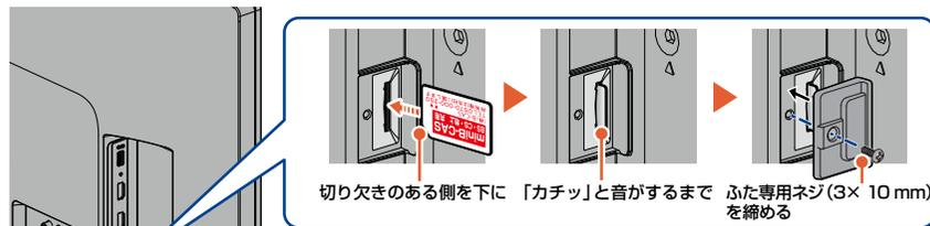
切り欠きのある側を下に「カチッ」と音がするまで ふた専用ネジ(3×10mm)を締める
