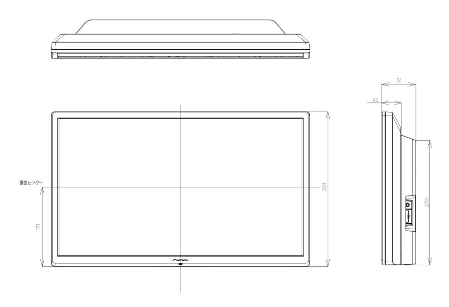
壁掛け金具(市販品)への取り付け用ネジ穴: M4ネジ(4箇所)
