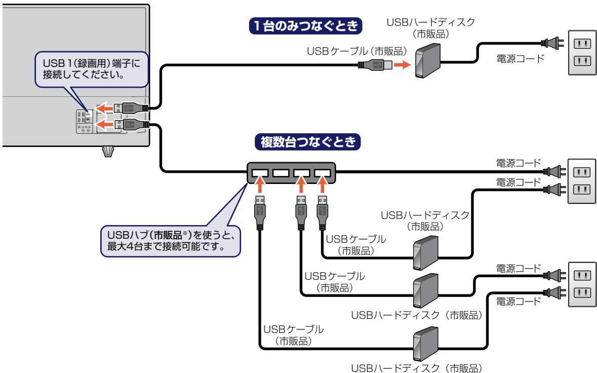
※ セルフパワー型のUSBハブは、当社接続確認済み機器をご使用ください。接続確認済み機器については、当社製品情報サイトの「接続確認済み機器」ページ([funai.jp/cs/device/](http://funai.jp/cs/device/))でご確認ください。
