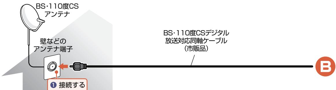
\*シールド性能が高いものをご使用ください。シールド性能が低いものでは、周囲のノイズの影響により受信性能が悪化する場合があります。
